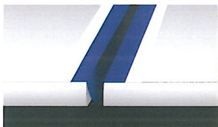
Schlaufenförmige Ausbildung von Mapeband im Dehnfugenbereich
